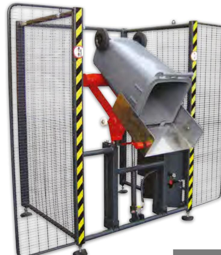
Grilles de sécurité conformes à la réglementation européenne ISO 13857
